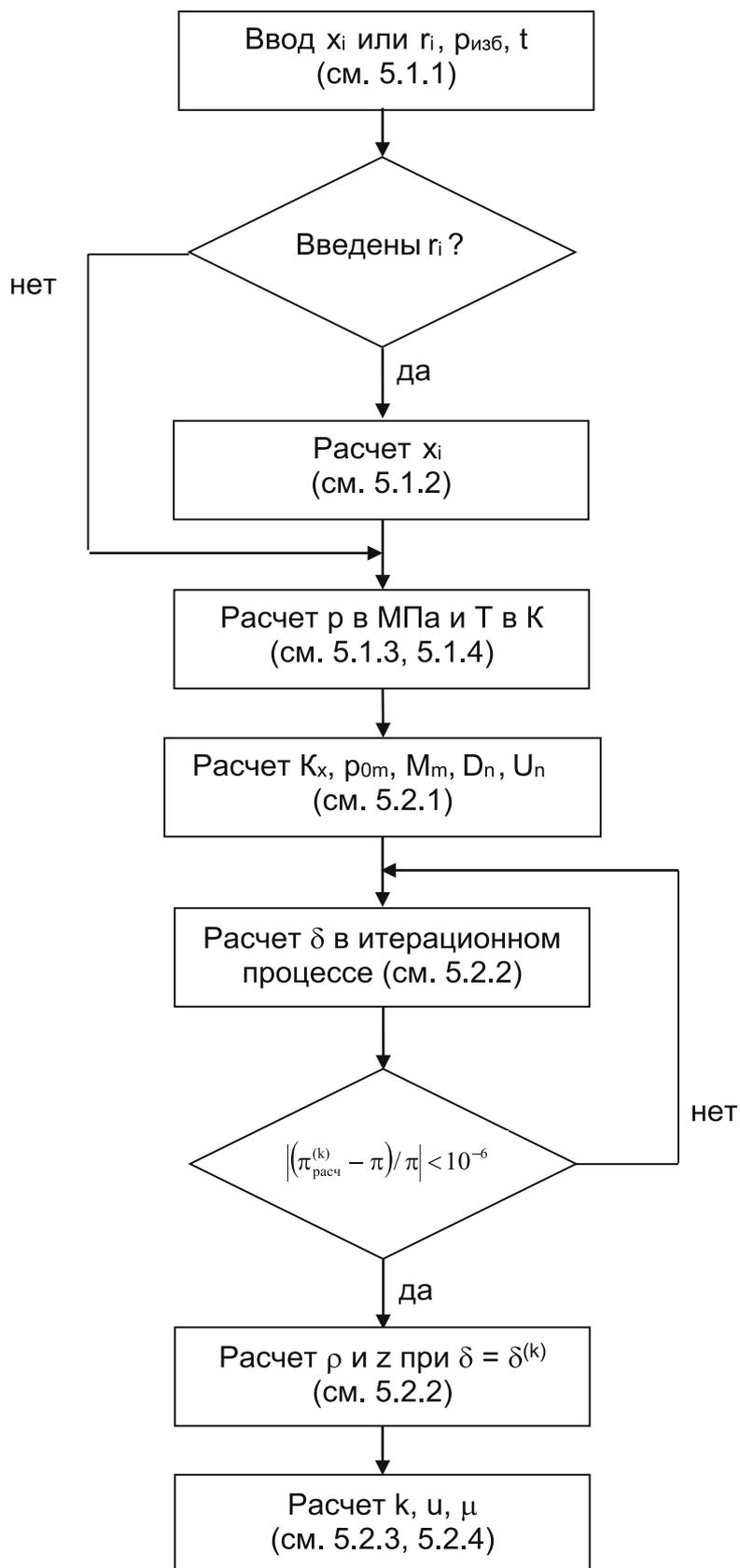
Рисунок 1 — Блок-схема расчета физических свойств природного газа
